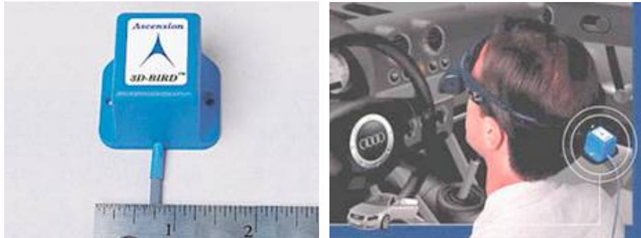
شكل ٢-٢٢ جهاز تتبع الحركة خفيف الوزن ولا يتجاوز أبعاده ٤ سم
