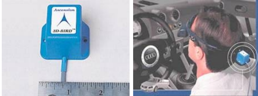
شكل (١٩) جهاز تتبع الحركة خفيف الوزن ولا يتجاوز أبعاده ٤ سم
